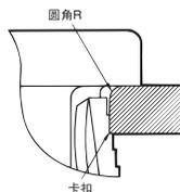
面板加工时的圆角R请在开关操作面一侧。
